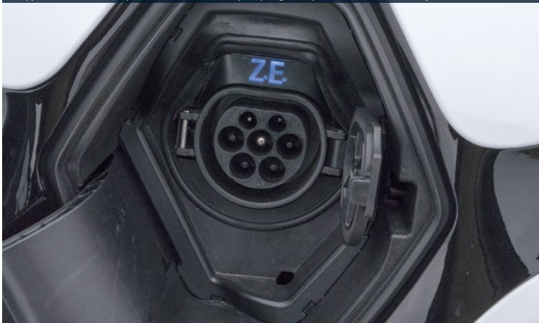
■ Typ 2 Mennekes – používa sa na všetkých plug-in hybridoch na AC nabíjanie
