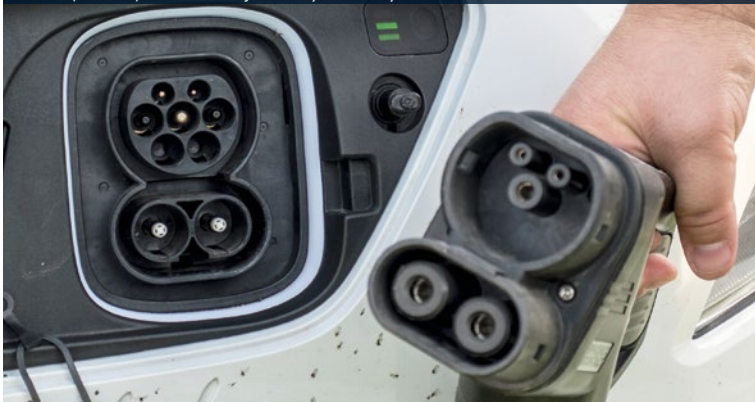
■ CHAdeMO – konektor určený iba na DC nabíjanie
