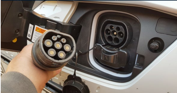
■ CCS2 (Combo) - Pri DC nabíjaní sa využíva celý konektor
